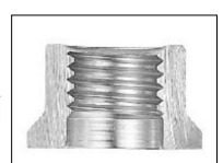
写真1 スカーナット断面
